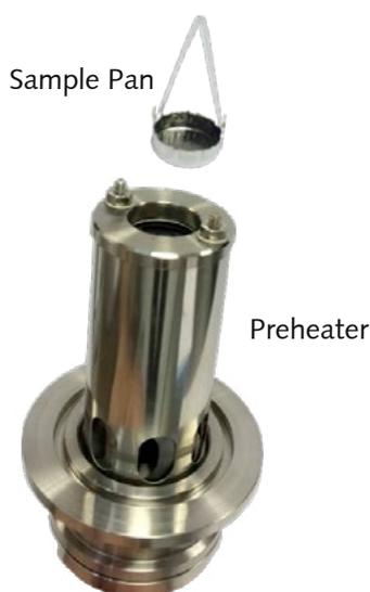
Pre-calentador de alta temperatura para de-gasificación/regeneración in-situ de muestras con capacidad hasta 400 °C. La temperatura es medida con un Pt-100 termopar colocado debajo del Sample Pan o plato de muestra.
